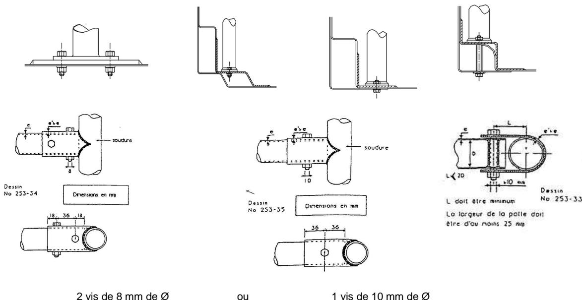
Des tubes de renfort supplémentaires sont autorisés dans la structure de l'arceau cage (tube à tube)
